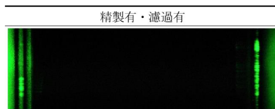
図 3.15 精製I形原料使用及び濾過導入後のアセトアミノフェン未飽和溶液における散乱
