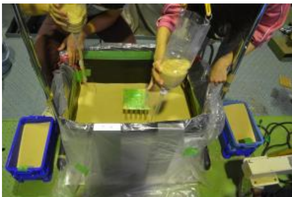
写真2-2 空中落下法による地盤作製の様子
