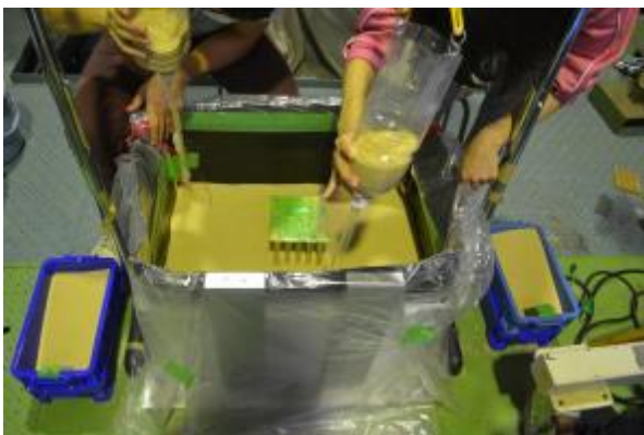
写真2-2 空中落下法による地盤作製の様子
