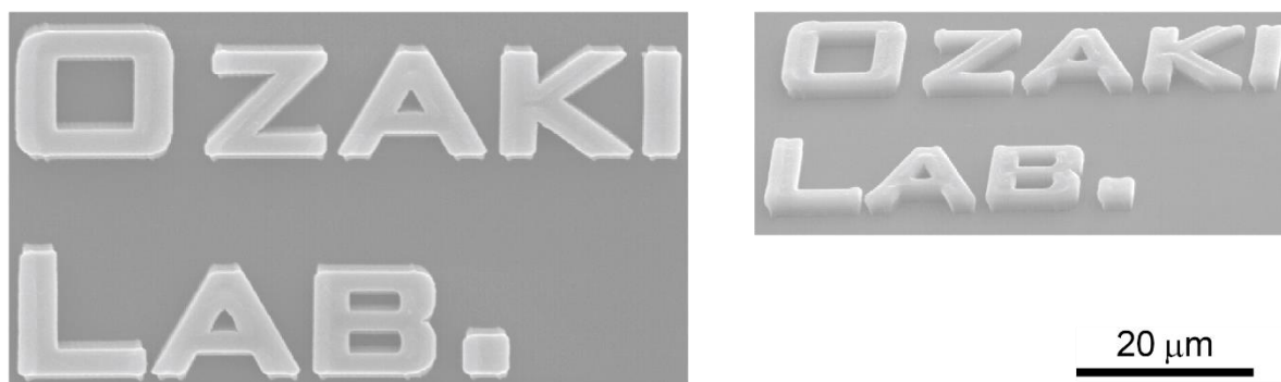
図 1.11 二光子光造形により作製した文字の SEM 像。
