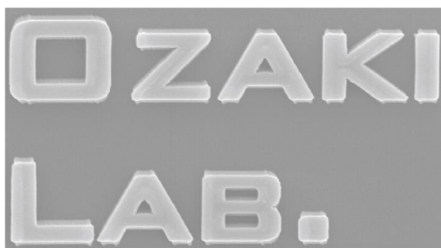
図 1.11 二光子光造形により作製した文字の SEM 像。
