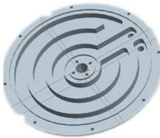
(b) 冷却水の流路
