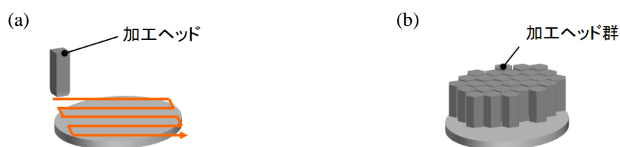
図 2.4.1 多電極型装置の概念 (a) 単電極全面走査型、(b) 多電極一括処理型
