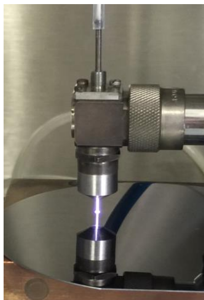
図 2.3.3 プラズマジェット加工の様子
