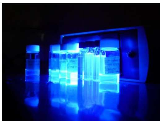
図 2-20 液体シンチレーターの発光
