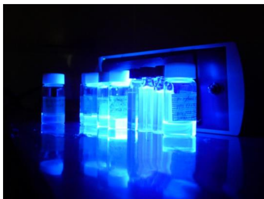
図 2-20 液体シンチレーターの発光
