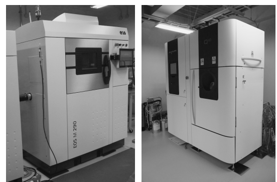
図5 金属積層造形装置：レーザービーム積層造形装置（左）と電子ビーム積層造形装置（右）。
