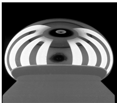
図1 大滴法による溶融金属の表面張力測定。
