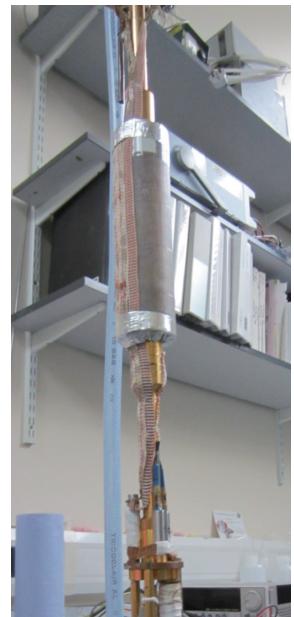
断熱消磁冷凍機のプローブ。上部に見える円柱状の物体が断熱消磁用の常磁性塩。
