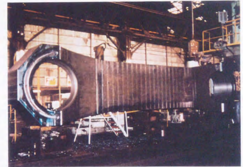
写真 5. 3 リンク本体の機械加工(SB)
