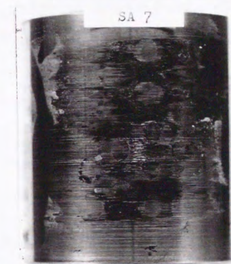
写真3. 10 4 \times 10^4 回連続試験後のピン・ブッシュ摩耗状況 (φ57)
