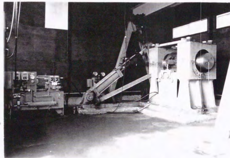
写真 3. 11 大型試験用三軸受型試験機
