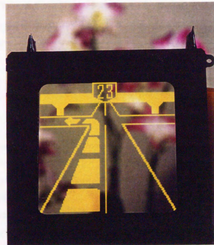
図 4. 8 4インチ型の透明な無機 EL パネル
