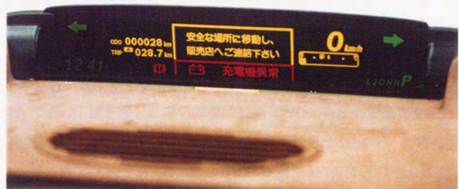
図4. 7 無機ELパネルを使ったインスツルメント・パネル
