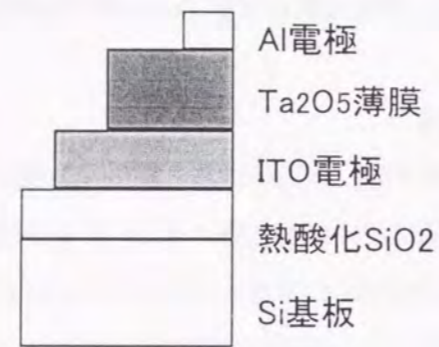
図 3. 1 評価試料の断面模式図
