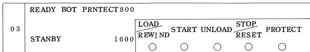
UNLOADスイッチを押し、前面窓を下げる、供給リールに磁気テープを押し込み、テープの先端をエアガイドに1cm程たらせます。
