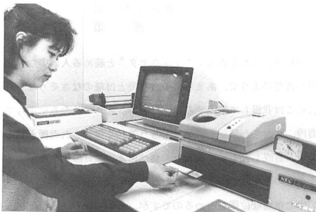
図2. ディスクユニットは、2ドライブで、計約280 kbyte のデータを記録できる。
