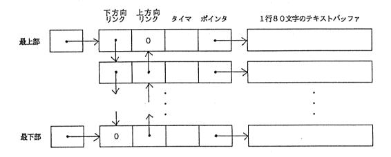
このように、データ構造は、テキストバッファとそのテキストバッファへのポインタで構 成されており、ポインタのテーブルは双方向のリンクリストで接続されています。このテキ ストバッファに対して外部から行なう操作として、4つの手続きが用意されています。
