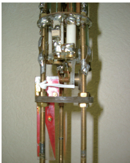
図 5.3.6 ^1\text{H} 、 ^{13}\text{C} 、 ^2\text{H} 三重共鳴プローブの共振部
