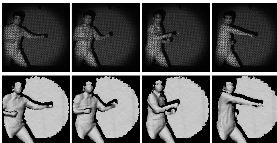
図 5.23: 近赤外線グリッドによるパンチ動作を再構成した人体の3次元形状.
