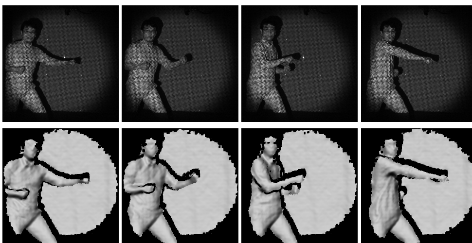
図 5.23: 近赤外線線グリッドによるパンチ動作を再構成した人体の3次元形状.
