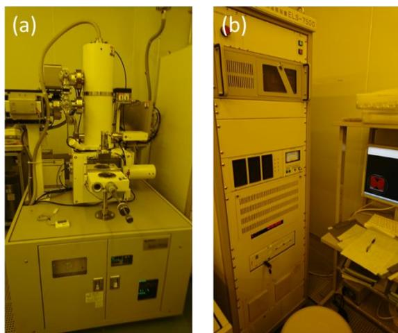
Fig. 3-5 ELS-7500 TFE 電子ビーム描画装置 (elionix)の外観。(a)描画装置本体と(b)パーソナルコンピューターを含むコントロールパネル
