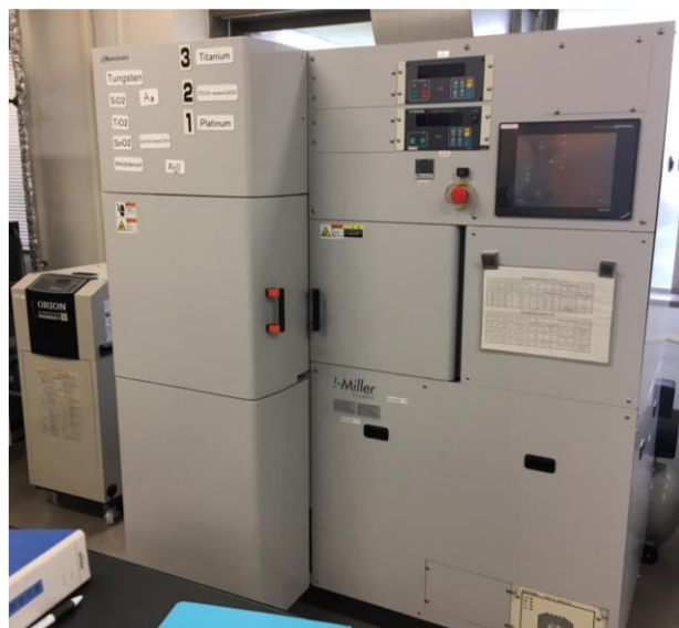
Fig. 3-6 芝浦メカトロニクス社製の CFS-4EP-LL スパッタリング装置の外観。
