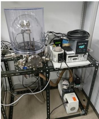
Fig. 2-8 自作蒸着装置の外観
