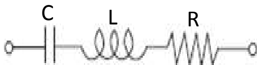
図 1-7 コンデンサの等価直列回路
