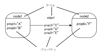
図 3.6 プロパティグラフモデル
