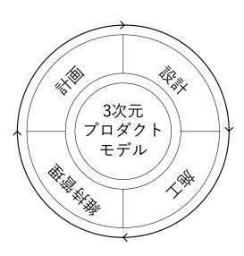
図 1.1 BIM/CIM の概念図
