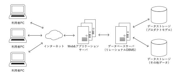
図 6.2 一般的な工事情報共有システムの構成
