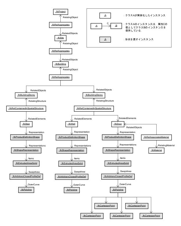
図 5.1 5F 建てビルディングのプロダクトモデルの一部 (UML オブジェクト図)
