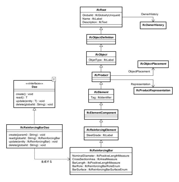
図 6.5 IfcReinforcingBar と Data Access Object (UML クラス図)
