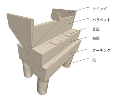
図 2.8 橋台の構造
