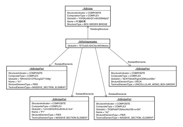
図 4.2 変換元 PC 箱桁橋プロダクトモデル (UML オブジェクト図)
