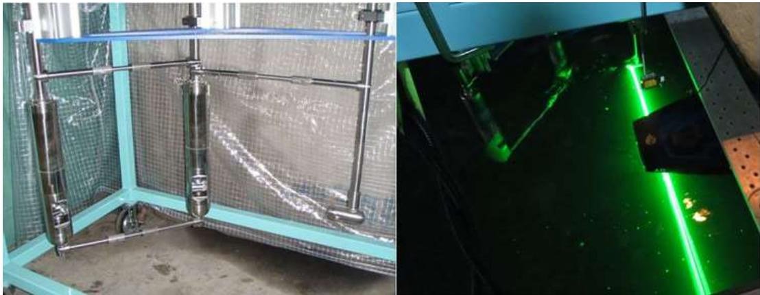
図 4.7 SPIV 計測システム外観(上：平面図, 左下：装置写真, 右下：計測時の様子)
