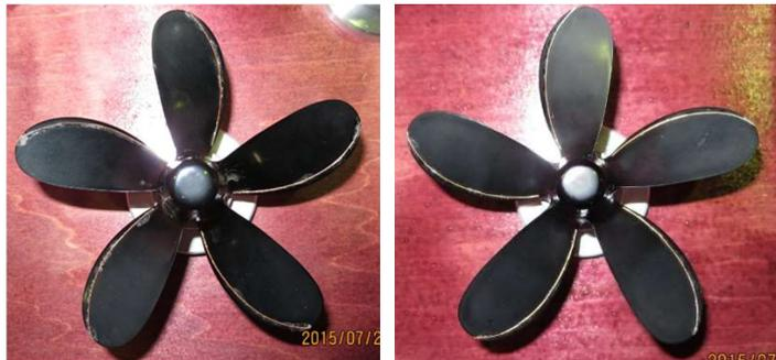
図 4.8 模型プロペラ(左：右回転用, 右：左回転用)
