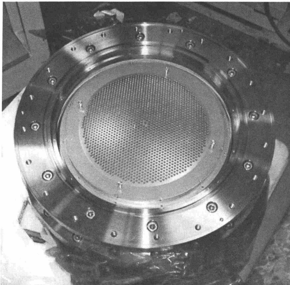
Fig. 3-2 イオン源の電極. 各電極の引き出し孔はそれぞれ同軸上にあけられており、電極の幾何的構造により引き出されるビーム束を収束する。
