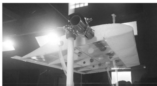
図 3 風洞内に翼を固定した様子
