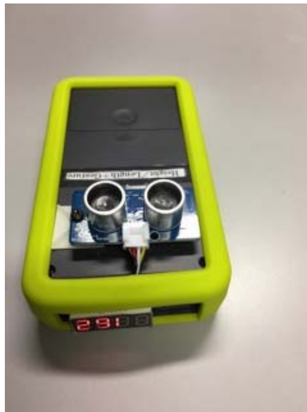
図 3-14 micro:bit を用いて作成した身長計
