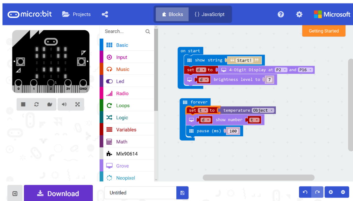
図 3-16 体温計のプログラミング (micro:bit in Blocks)
