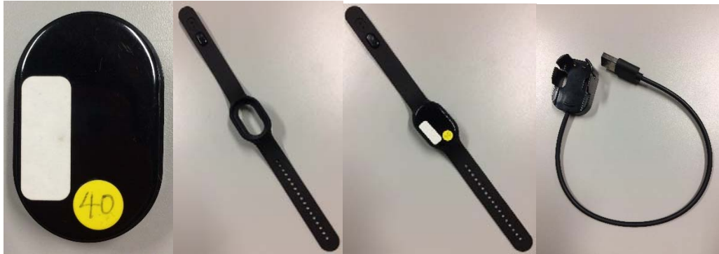
図 4-2 子ども位置と生理データを測るセンサ（左）、バンド（左中）、センサがついたバンド（右中）、充電器（右）
