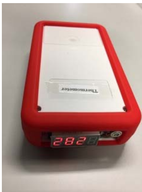
図 3-18 micro:bit を用いて作成した体温計
