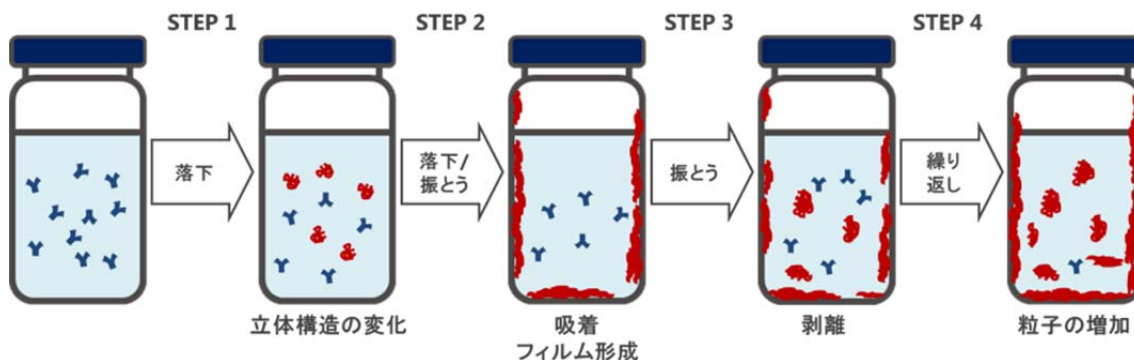
Figure 17. 落下・振とう複合ストレスによる凝集体生成経路に関するモデル
