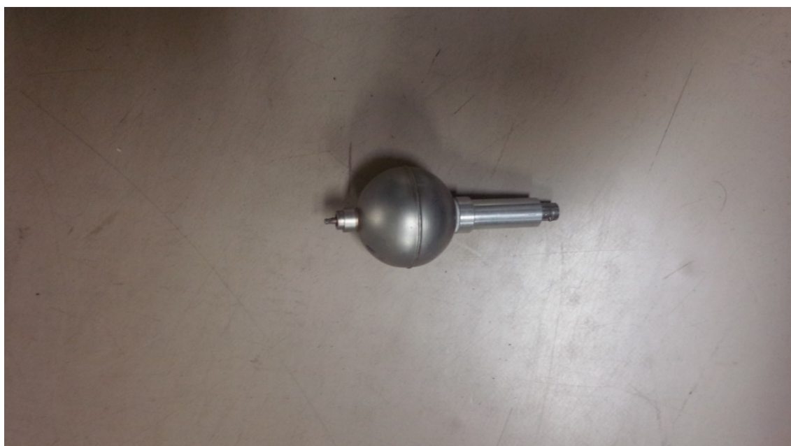
Fig. 2-3 本研究で使用した ^3\text{He} 充填比例計数管。直径 50 mm (2 inch), 内圧 1 MPa, 動作電圧 1250 V である。
