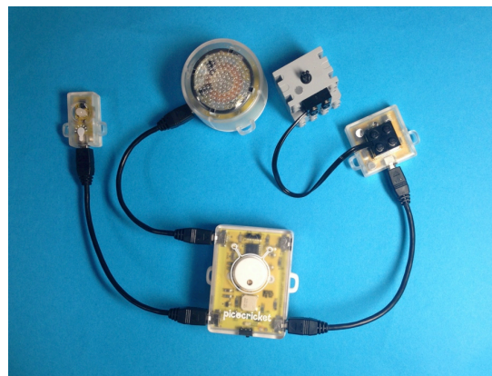
図 4-1-2 PICOcricket とモーター、ライト、スピーカー
