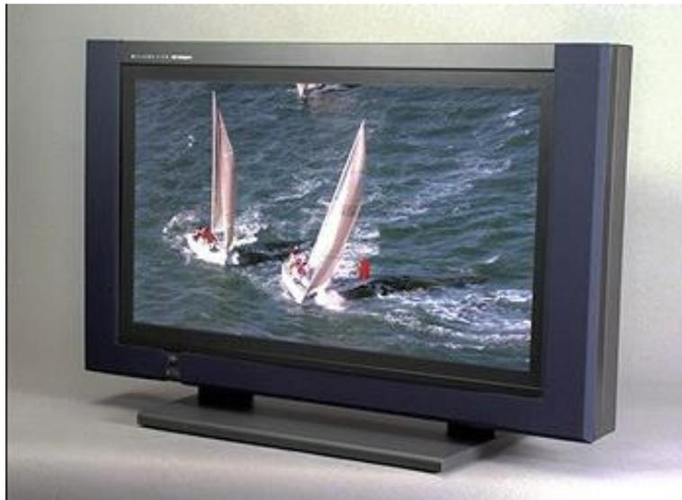
図 3.16 開発した対角 42 インチ高精細ハイビジョン PDP ディスプレイ [46]
