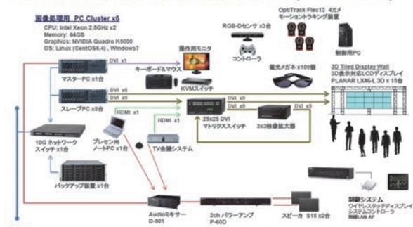
図5：高精細立体表示装置@うめきた (シンドリカル立体表示システム)の構成
