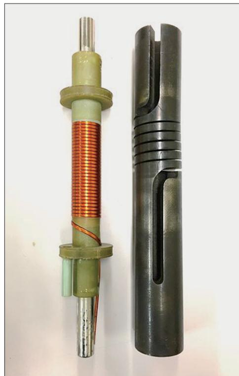
図5 左は製作途中の金道式マグネット。外部補強はまだ施されていない。右は2層タイプの伊達式マグネットの内コイル。
