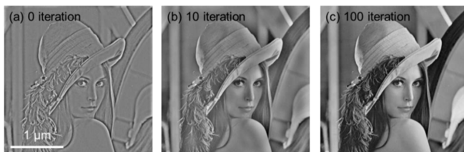
図 5-4 CG-MAL 法によって再構成された位相分布. (a) 初期波動場. (b) 10 回反復後. (c) 100 回反復後.
