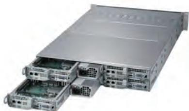
図3 汎用 CPU ノード (LX 2U Twin2 Server 406Rh-2) の外観
