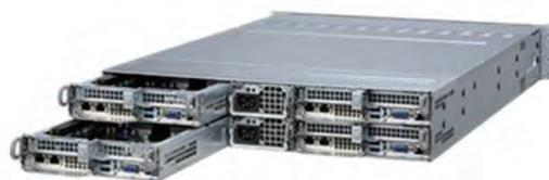
図 7 Xeon Phi ノード (Express5800/HR10c-M) の外観
