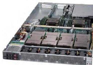
図5 GPU ノード (LX 1U 4 GPU Server 102Rh-1G) の外観
