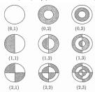
図 1:円形太鼓の固有振動の形
