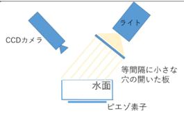
図3:水面の振動の形を観測する装置
