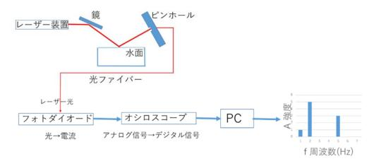
図2:自然な状態での水面の振動を測定する装置
