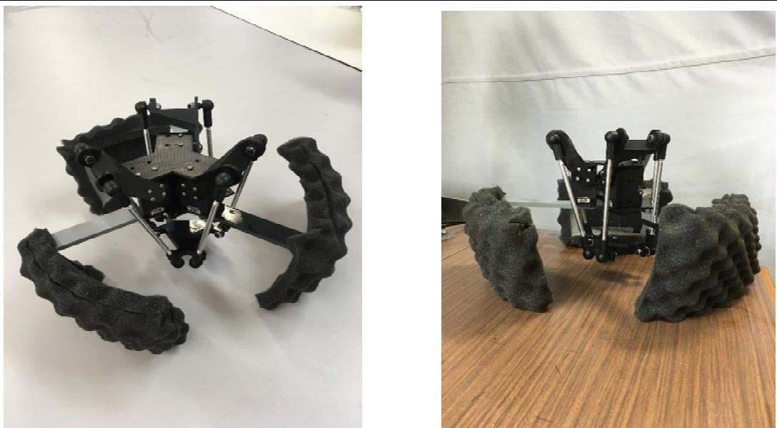
図 2：停止状態のデルタリンクロボット
