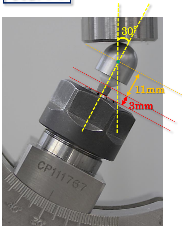
図2 インプラント体および試験体を設置した状態
