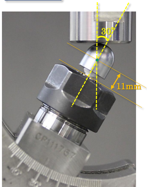
図2 インプラント体および試験体を設置した状態
