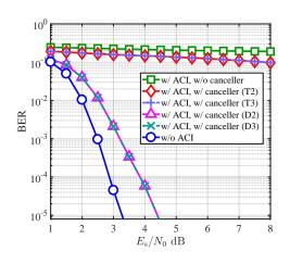
図 3.7: シナリオ 1,  $E_{\text{diff}} = -25 \text{ dB}$  に おける STA1 の信号の BER 特性
