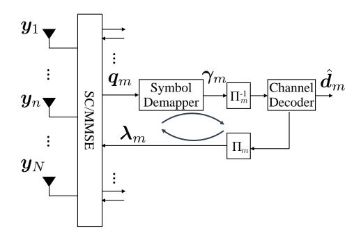
図 2.2: SC/MMSE ターボ等化機能を持つ MIMO 受信機構成
