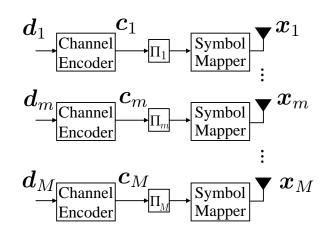
図 2.1: MIMO 伝送の送信機構成
