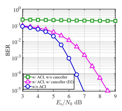
図 3.8: シナリオ 2,  $E_{\text{diff}} = -20 \text{ dB}$  における STA1 の信号の BER 特性
