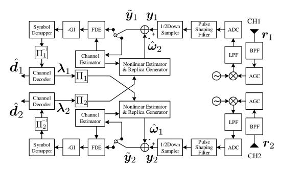
図 3.3: マルチチャネル受信機の構成
