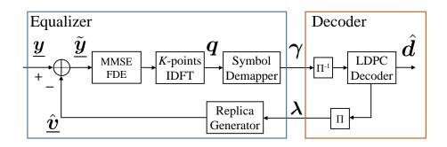
図 5.3: シングルキャリア型セルフコヒーレント伝送のためのターボ等化器の構成
