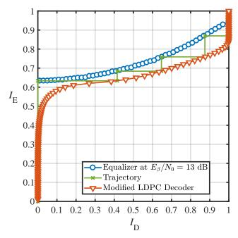
図 4.6:  $E_{\beta}/N_0=13~\mathrm{dB}$  の等化器出力に最適化した LDPC 符号に関する EXIT チャート
