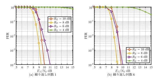
図 5.7: AWGN 通信路に最適化された LDPC 符号を使用した場合の FER
