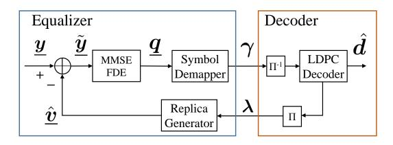
図 4.3: マルチキャリア型セルフコヒーレント伝送のためのターボ等化器の構成
