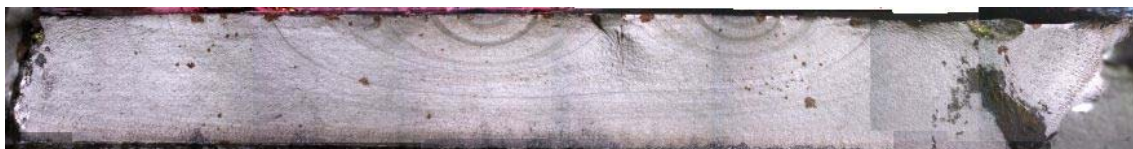
Fig. 2.21 Fatigue fracture surface (T2).
