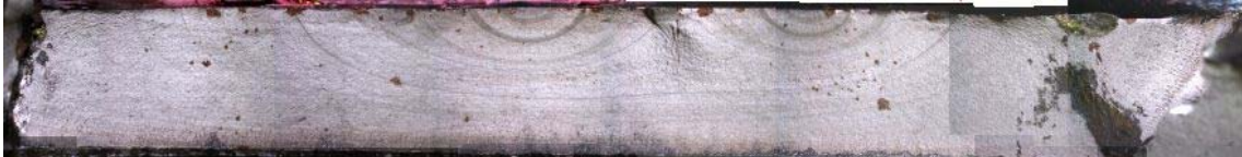
Fig. 2.21 Fatigue fracture surface (T2).
