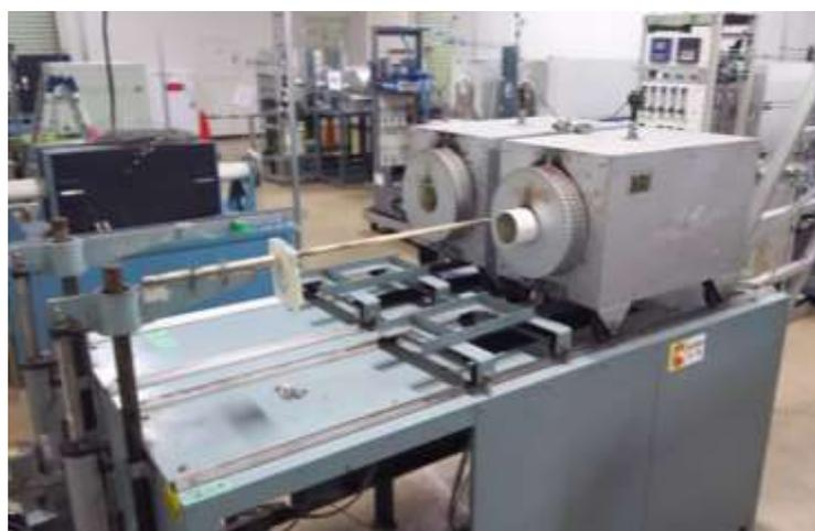
Fig. 5.2 繰り返し酸化試験装置 外観写真
