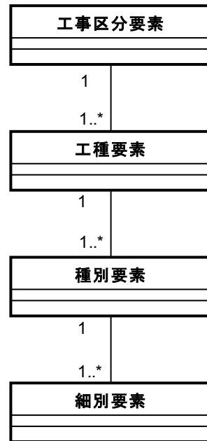
図 6-5 3次元プロダクトモデルの要素と階層構造
