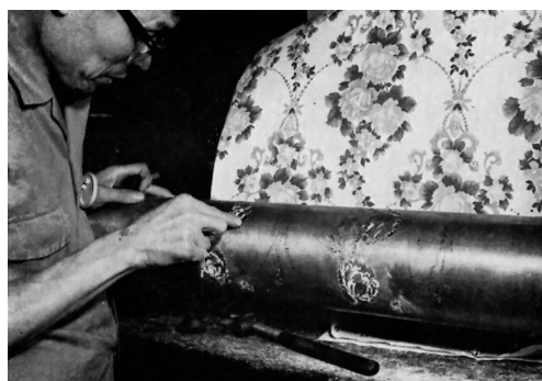
図11 グレーバーによる銅ロールの手彫り彫刻（『徳岡工業株式会社とそのグループ』（50年誌）56頁より）
