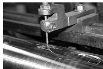
図14 左：1960年代のポンチング作業（『徳岡工業50年誌』56頁より） 右：ポンチングマシン再現（2018年徳岡工業株式会社にて、筆者撮影）
