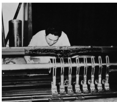
図10 ペンタグラフによる銅ロールの機械彫刻 （資料提供 京美彫刻株式会社）
