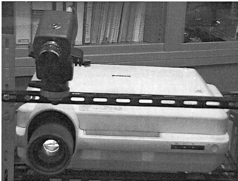
Fig.3-3 強度変調モアレの計測システム
