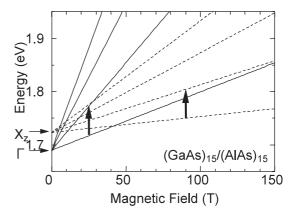
図7 (GaAs)。/(AIAs)。超格子の 点とX点とが形成するランダウ準位の磁場強度依存性。矢印は波長23μmの光エネルギーによる吸収が起こる位置を示している。
