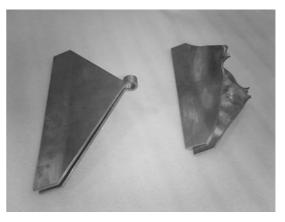
図4 一巻コイルの放電前(左側)と放電後(右側) の写真。三角形状の先端に形づくられた小さ なコイルが、放電によって吹き飛んでいる。
