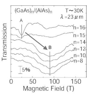
図 6 (GaAs )/(AIAs )超格子の超強磁場サイクロトロン共鳴の測定結果。試料温度は約30K、検出用の光レーザにはH<sub>2</sub>Oレーザの波長23μmを用いた。
