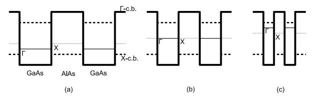
図1 (GaAs)/(AIAs)超格子の伝導帯を模式的に表した図。太い実線は 点を、太い点線はX点を表し、細い実線、細い点線は、それぞれの井戸層内での基底準位を表している。超格子の積層数nは(a)(b)(c)となるに従って小さくなっている。
