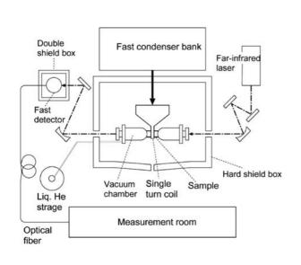
図5 超強磁場サイクロトロン共鳴測定に用いた測 定系。
