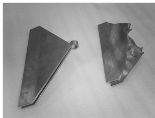
図4 一巻コイルの放電前（左側）と放電後（右側）の写真。三角形の先端に形づくられた小さなコイルが、放電によって吹き飛んでいる。
