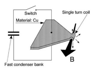
図3 一巻コイル法超強磁場発生の原理。放電速度 の速いコンデンサ・バンクに充電された電荷 を、一巻コイルに一気に放電させて超強磁場 を得る。
