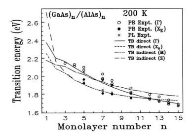
図 2 (GaAs)/(AIAs)超格子における電子の遷移エネルギーの積層数n依存性。 印と 印がフォトリフレクタンス測定の結果、×印がフォトルミネッセンス測定の結果、そして、各線が第 2 近接sp³強結合近似法による計算結果を示している。
