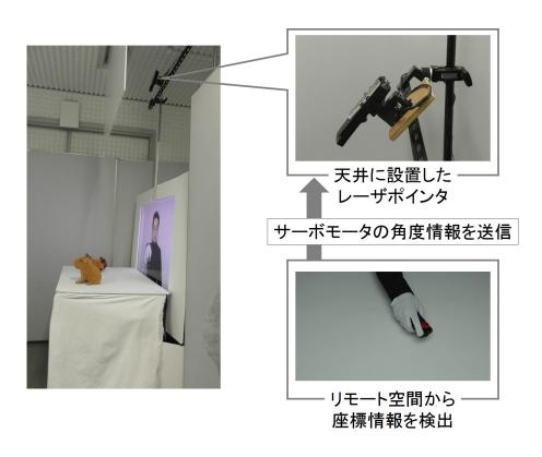
図 3-10 レーザポインタによる遠隔ポインティングの構造
