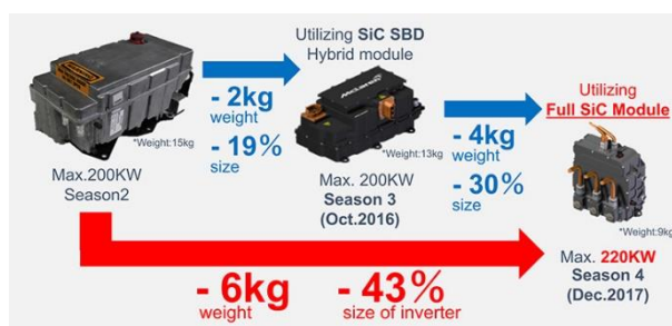
図 1-3 WBG 半導体デバイス適用時における電源回路の小型化例[9]
