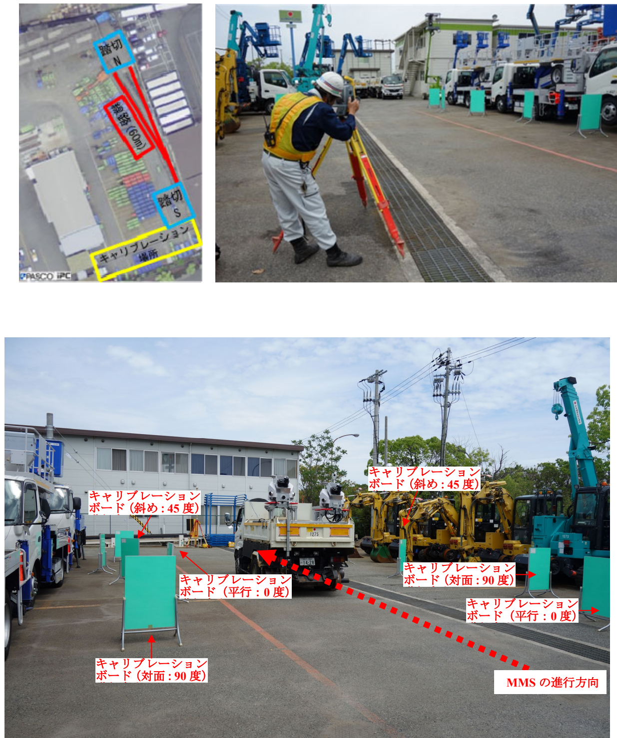
図-4.5 実験場所概観（左上）と平面（ボード）測定（右上）キャリブレーションボード配置（下）
