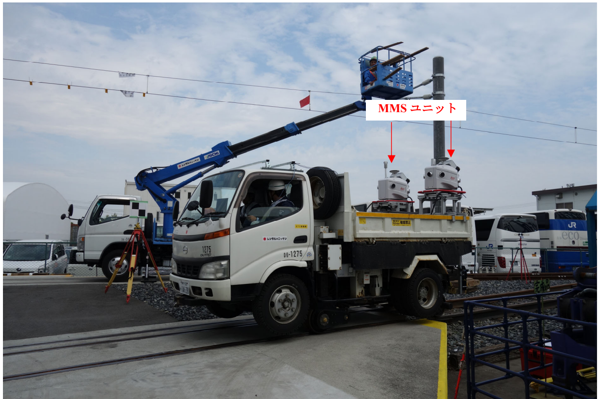
図- 4.1 2 台の MMS ユニットの外観
