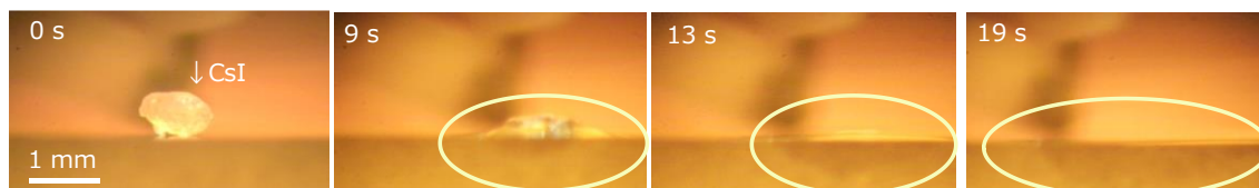
図 4.15. SUS316(Si_1.0 wt%)固体表面で溶融する CsI の外観.
