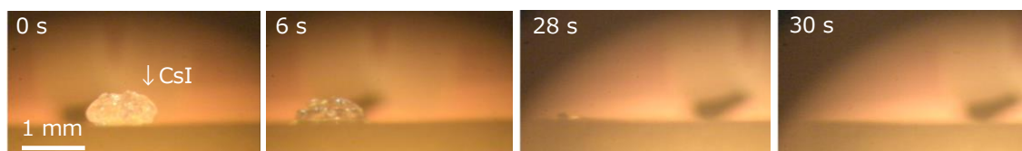
図 4.6. SUS316(Si_0.2 wt%)固体表面で溶融する CsI の外観.
