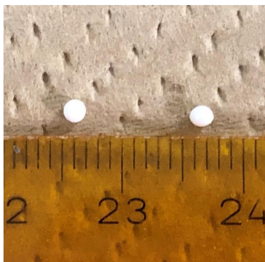
図 3-3 作製試料外観 (左; Al_2O_3 右; ZrO_2 )
