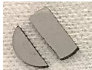
図 3-19 \text{Al}_2\text{Fe}_3\text{Si}_3 試料の外観
