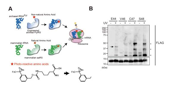
図 27. (A)部位特異的光クロスリンク法の原理。(B)(A)を用いた G0S2 の結合探索。HEK293T 細胞へのトラスフェクション 24 時間後 UV 照射および免疫沈降法を行い western blotting から評価した。矢印は G0S2 に対する結合タンパク質として推測されるバンド。\*は G0S2 の多量体を表す。
