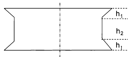
図7 両端部を円錐台型に加工したスペーサ fig 7. A spacer with two frustums at both ends
